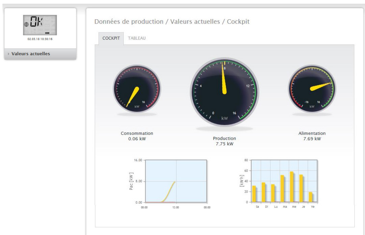
Fig. : Valeurs actuelles d'un exemple d'installation (vue Cockpit)
