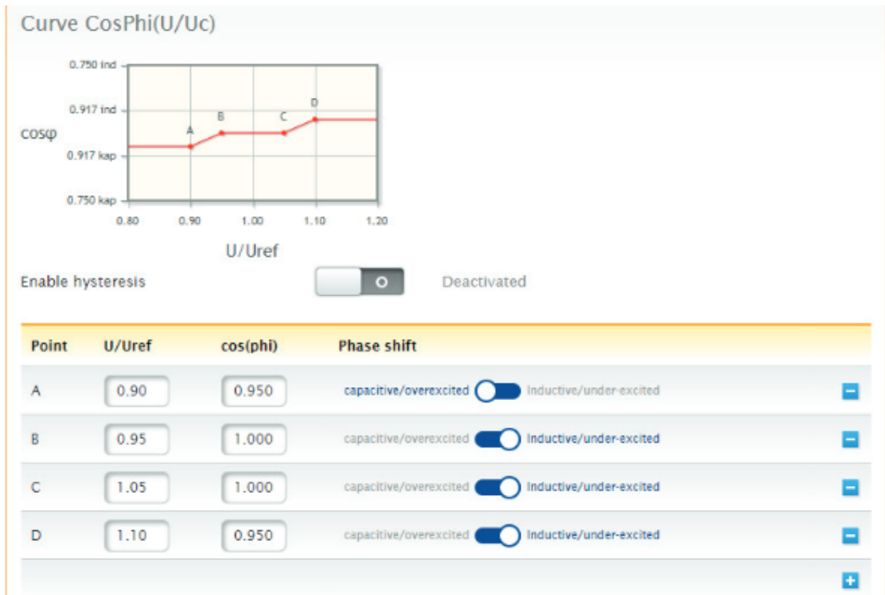
Fig. : Courbe cos(Phi)(U/Uc) avec valeurs d'exemple
