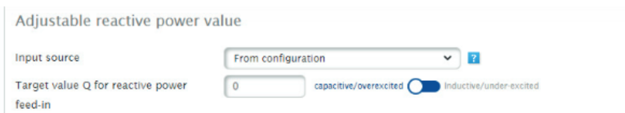
Fig. : Puissance réactive réglable avec source d'entrée
